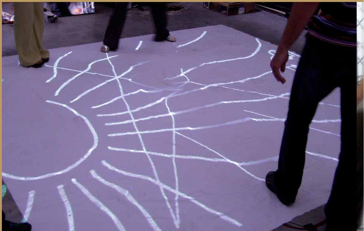
Das Netzwerkspiel wird über 17 Bodentaster interaktiv gesteuert. Die Software erkennt welche Taster eine gültige Netzwerkverbindung ergeben, baut dann mittels Computergrafik und Computeranimation die richtigen Verbindungen auf und projiziert diese auf den Boden.
