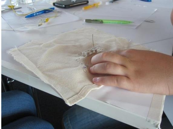
Der Stromkreis kann entweder direkt in das Kleidungsstück genäht werden - dann ist aber zu überlegen, wie der dunkle Faden am besten in das Motiv integriert werden kann. Oder der Stromkreis wird auf ein eigenes Stoffstück genäht, das von innen ans T-Shirt geheftet wird. In diesem Fall werden die LEDs von außen durch das T-Shirt und das Stoffstück gestochen und dann innen mit dem Stromkreis verbunden.
