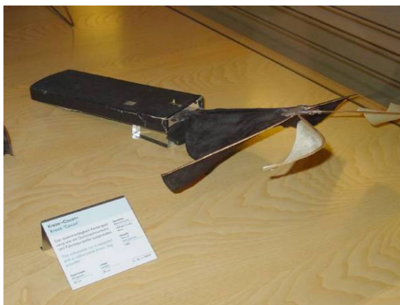
Abb. 11: Dieses Bild zeigt das Gummiband -Flugmodell von Wilhelm Kress (1880), ca. 30 cm breit und insgesamt 40 cm lang. Erwähnenswert sind die Propellerflügel, ähnlich groß wie die Tragflügel. Die Spannvorrichtung befindet sich in einem Holzkasten an der Rückseite des Flugzeuges.
