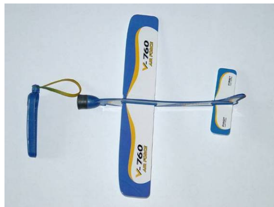
Abb. 10: Das Gummiflugmodell. Es handelt sich um ein aus leichtem Styropor gefertigtes Flugzeug und einem Handgriff mit Gummiband.
