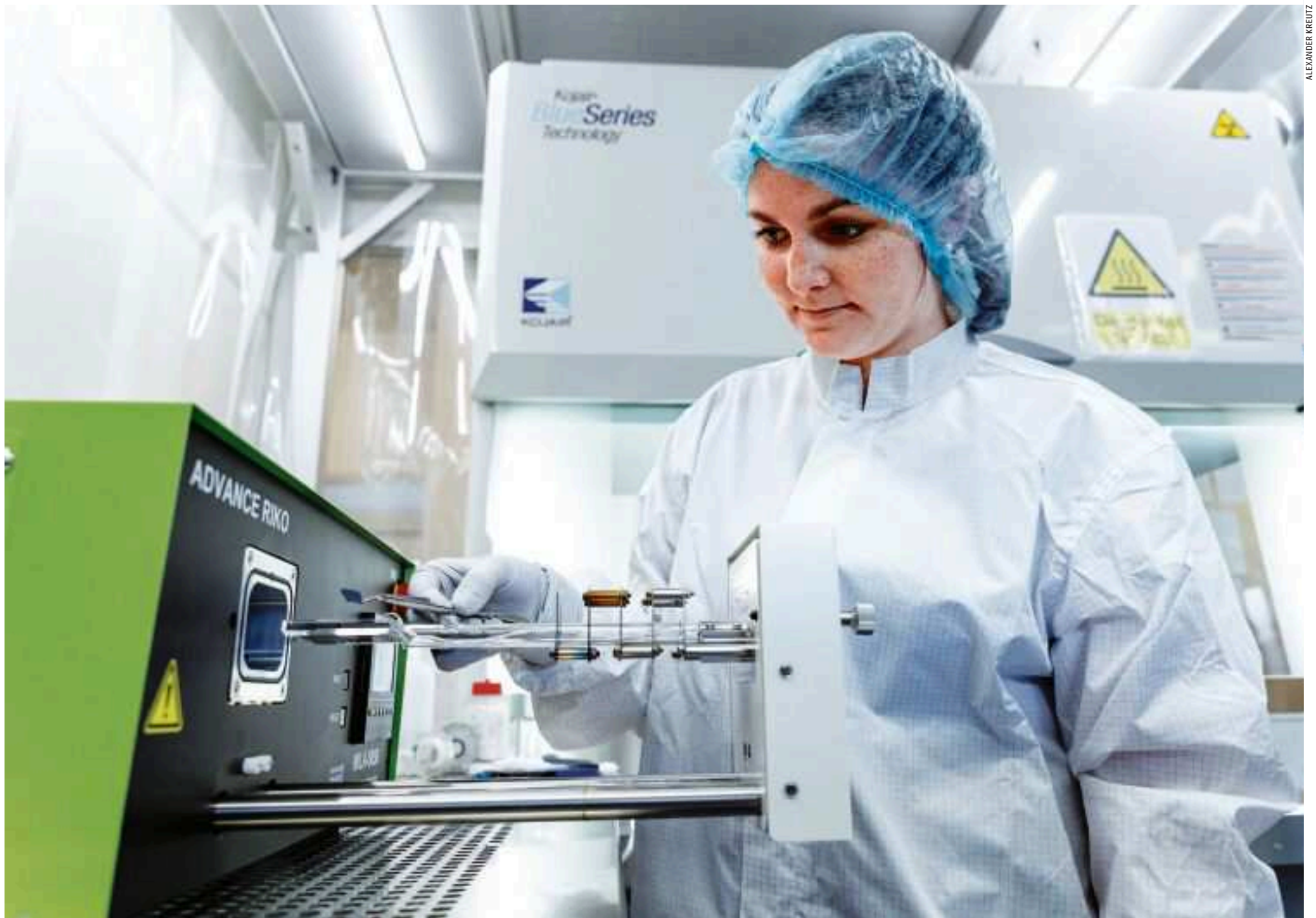
Temperaturnachbehandlung des Grundmaterials zur Herstellung eines Dünnschichtkondensators
