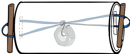
5. Spanne das Gummiband, indem du die Stbchen in entgegengesetzter Richtung drehst.
